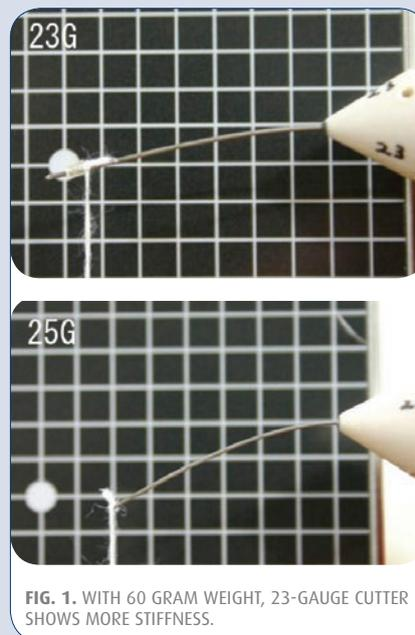
FIG. 1. WITH 60 GRAM WEIGHT, 23-GAUGE CUTTER SHOWS MORE STIFFNESS.
